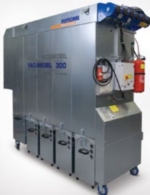
Рис. сверху: Vacumobil JT 300 с импульсной регенерацией сжатым воздухом
