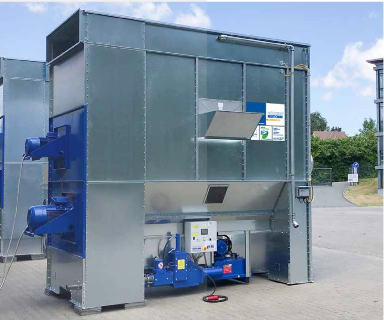
Рис.: MultiStar C 6/4 с брикетировочным прессом
