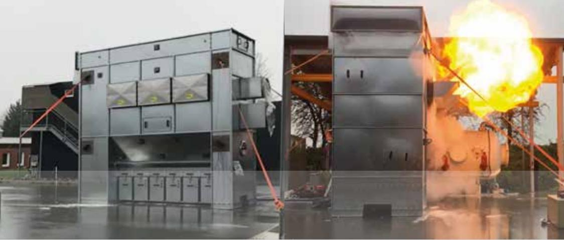
Тест на взрывобезопасность при 220 мбар
