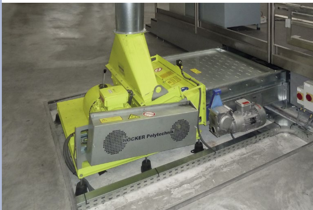
Шредер PHSS-K/B Удаляет отходы высечки и боковой передней кромки
