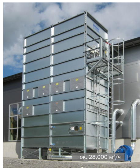
Фильтр MultiStar с каналом обратного воздуха • производство термодревесины
