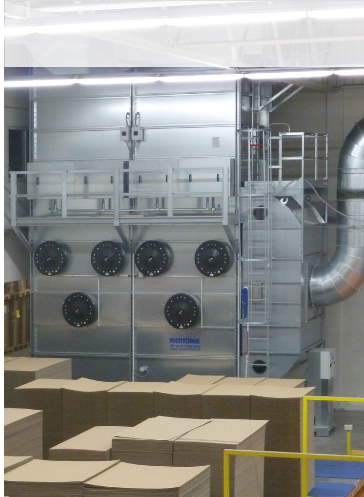
Фильтр MultiStar с импульсной регенерацией в производстве упаковки
