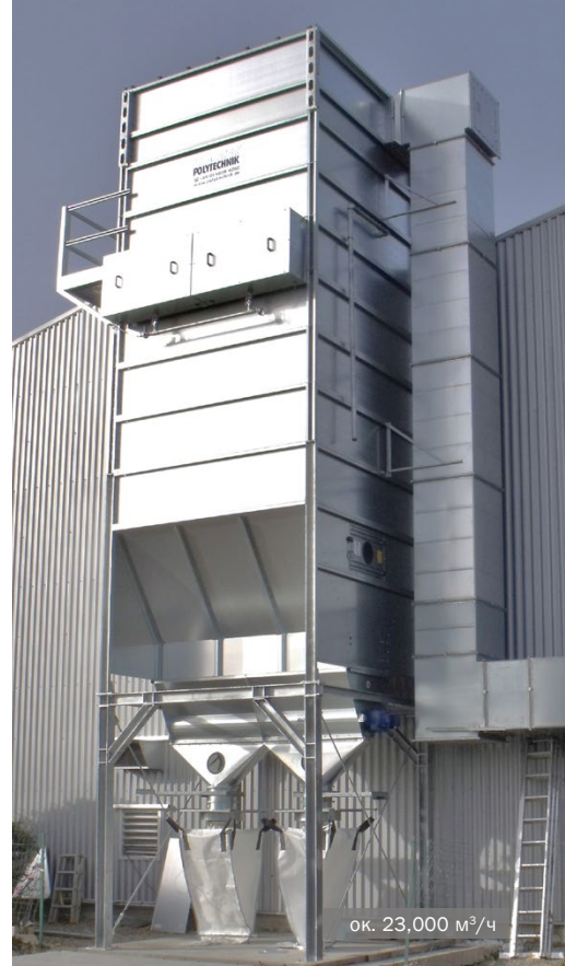
Фильтр MultiStar с импульсной регенерацией в производстве пластика
