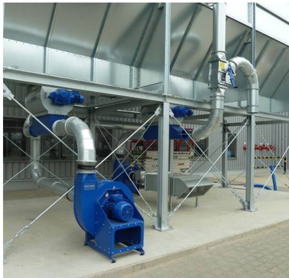
Гибкая выгрузка в транспорт с двумя выходами
