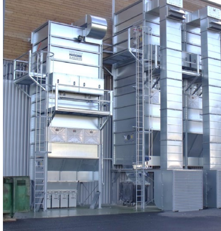
Фильтр MultiStar с импульсной регенерацией в перерабатывающей промышленности
